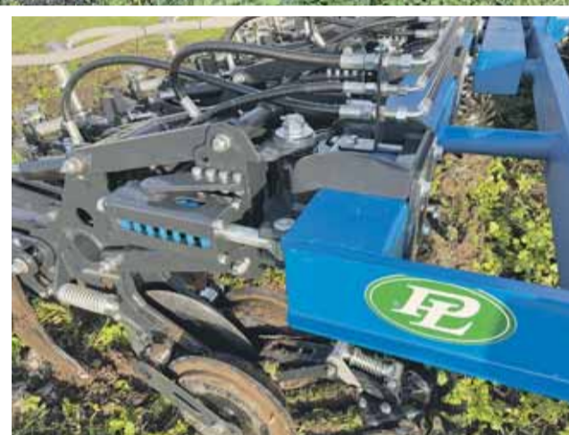
Autorsky chráněný P&L systém horizontálního pružinového jištění pracovních jednotek stroje Ferti Tiller 900.
