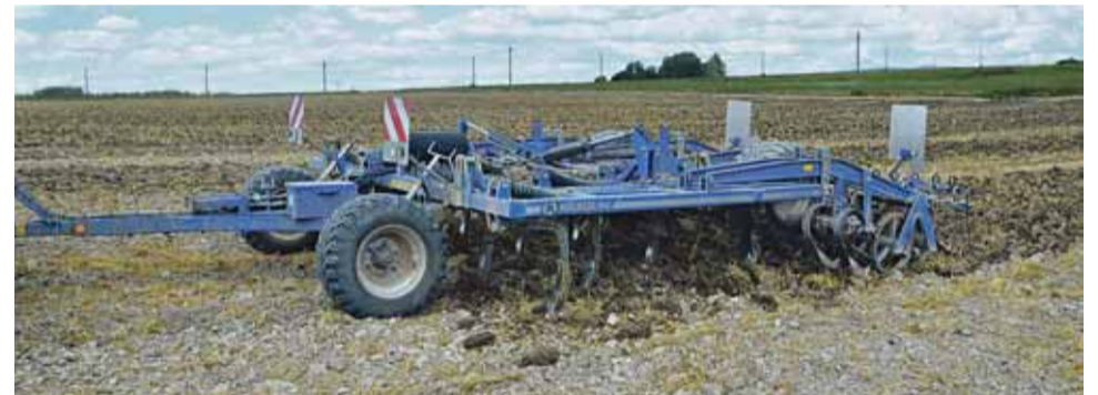
Pracovní hloubku kypřiče lze nastavit od 5 do 30 cm.
