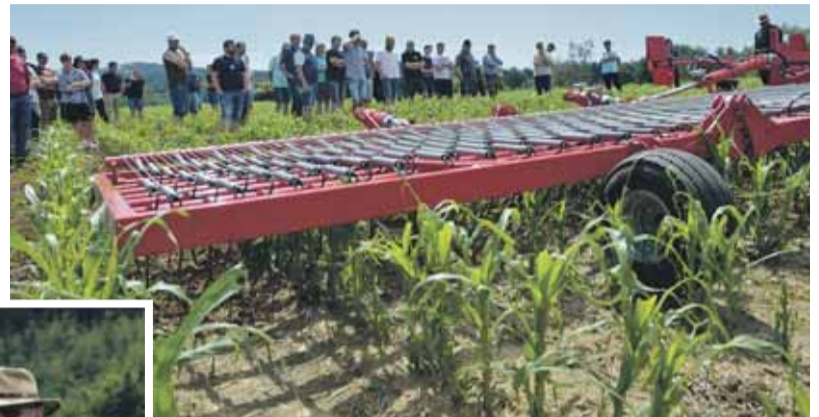
Prutové brány HORSCH Cura mechanicky likvidují plevel.
