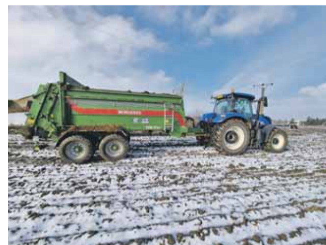
Rozmetadlo Bergmann TSW 2120T disponuje objemem 8,6 m 3 .
