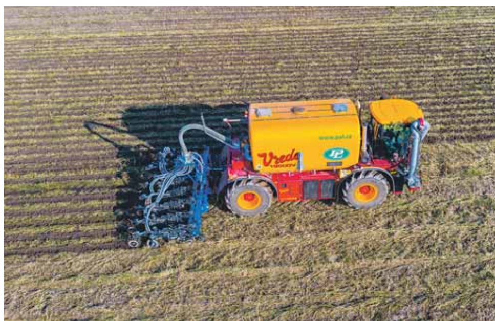
Stroj Muck Tiller 600 při aplikaci digestátu do meziplodiny v agregaci s Vredem.
