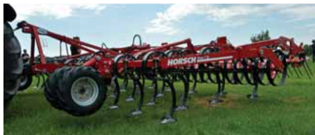
HORSCH Finer disponuje radličkami, u nichž lze nastavit přesný řezný úhel.
