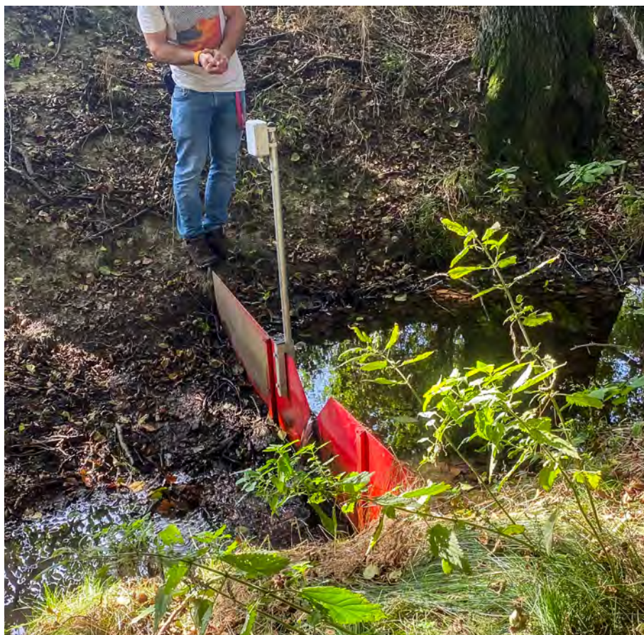
Thomsonův měrný přeliv – vzdáleně připojen k databázi zasláá informace o objemu vody
